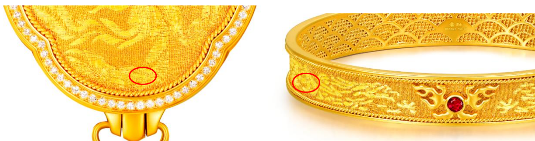
图 B.3 典型缺陷示例-图案模糊放大效果
