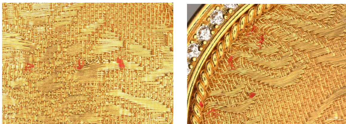
图 B.2 典型缺陷示例-起拱放大效果
