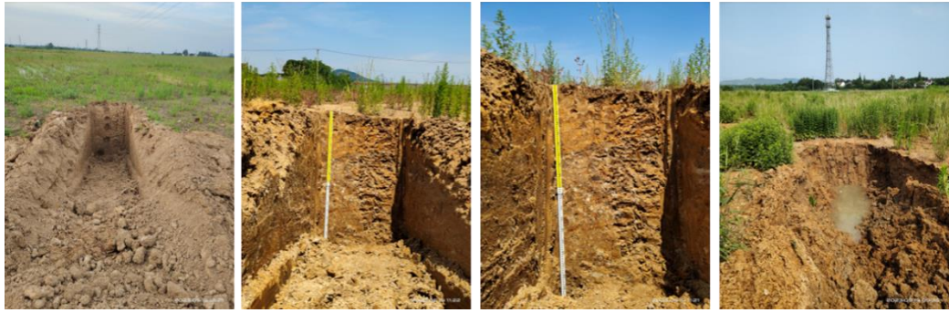
图 3 典型地块 0-2m 深土体剖面调查取样现场图
