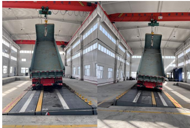
图 2 后倾式自卸车辆举升稳定性试验-空载
