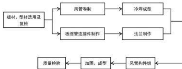
图5.2.1 金属风管制作工序
