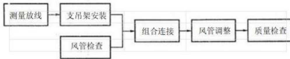
图7.2.1 战时通风风管构件安装工序
