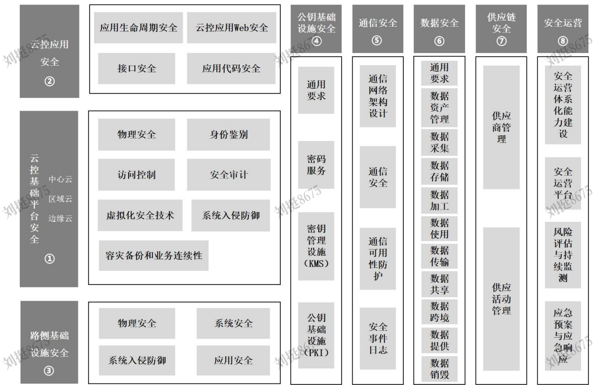
图 2 车路云一体化系统云控平台信息安全架构
