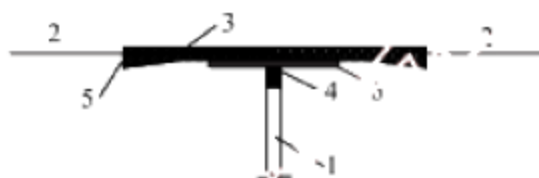
图 8.3.1 涂刷法处理结构缝渗漏示意图
