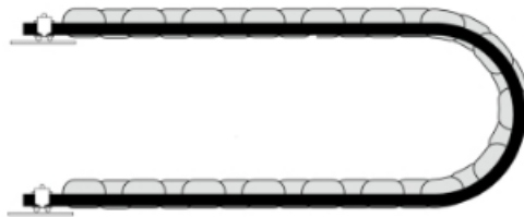
图 B.2 拖链内布线示意图
