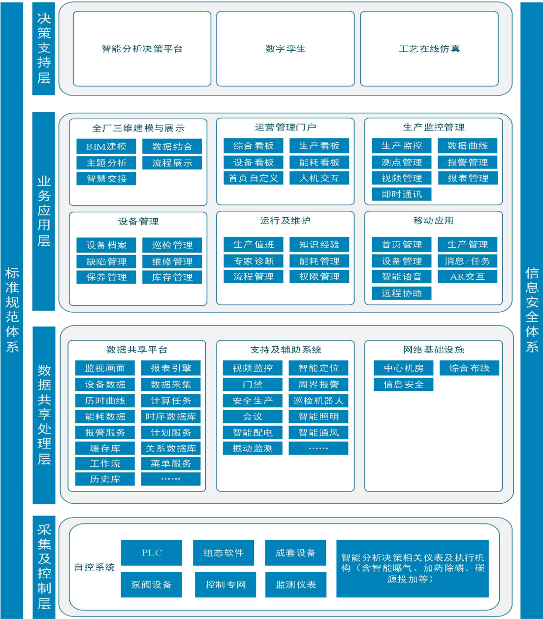
下沉式再生水厂智能化系统架构图
