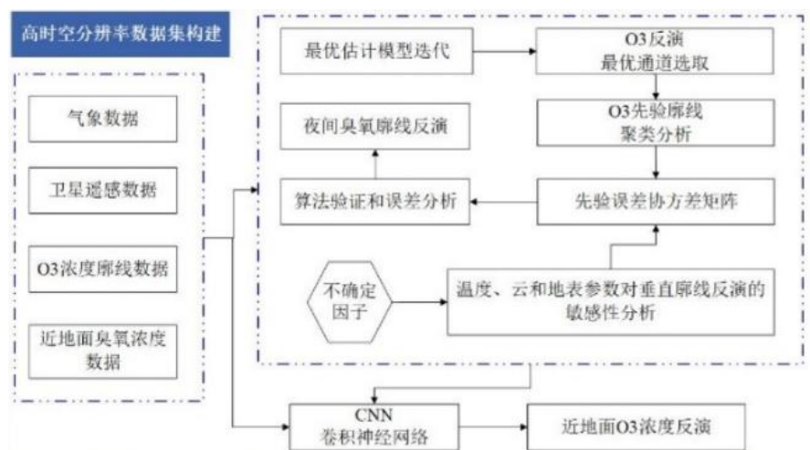
图 1 卫星遥感反演臭氧廓线和近地面臭氧浓度技术流程图
