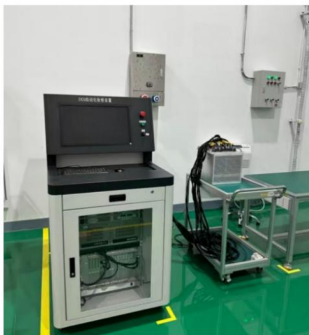
图 11 牵引控制单元试验台
