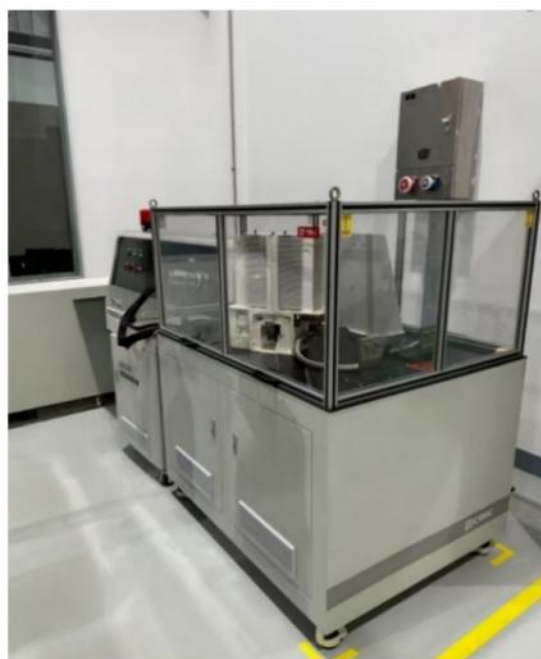
图 10 高速断路器试验台
