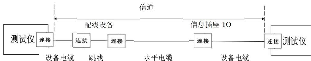
图 A. 1. 2 布线信道测试架构
