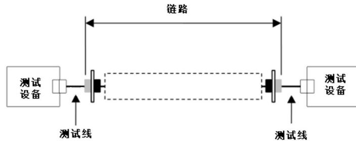
图 A.2.1-2 光纤链路测试参考模型
