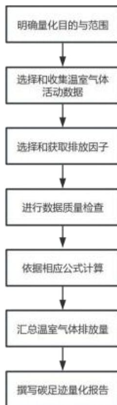
图2 废旧机电再制造产品碳足迹核算工作流程图
