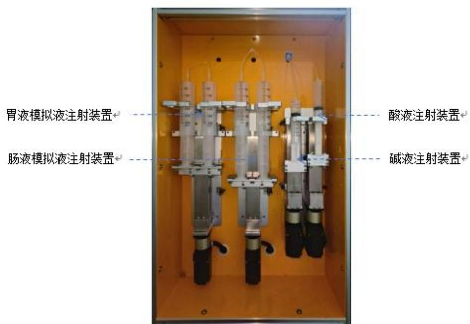
图 A. 2 消化液模块图示
