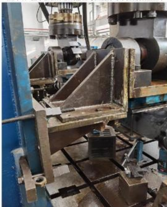
照片 2: 挂车轴轴体总成垂直弯曲刚度、静强度检测台架百分表布置照片
