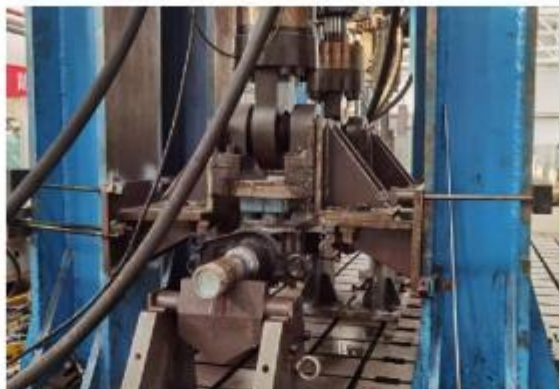
照片 1: 挂车轴轴体总成垂直弯曲疲劳寿命检测台架照片
