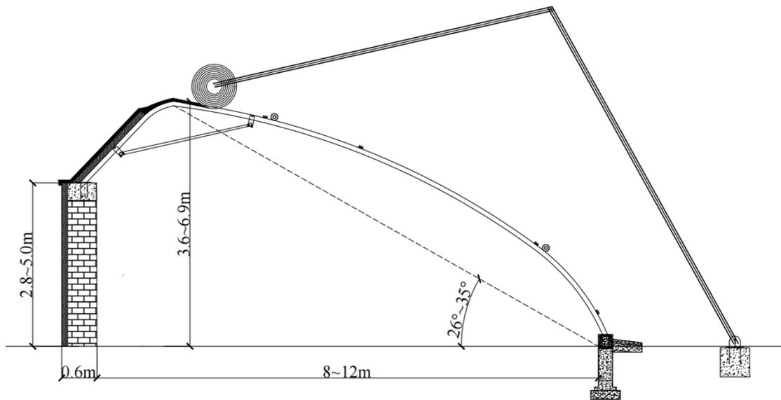
大荷载地区老旧银川二代砌筑日光温室改造剖面示意图
