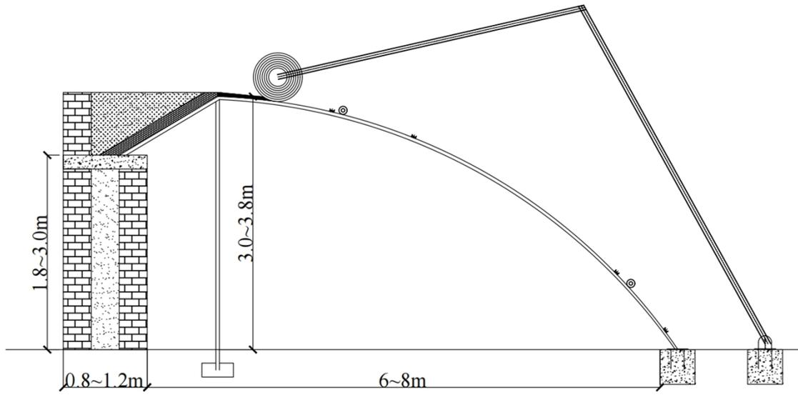
老旧银川二代砌筑日光温室无立柱改造剖面示意图
