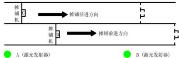
图 2 域激光发射器架设示意
