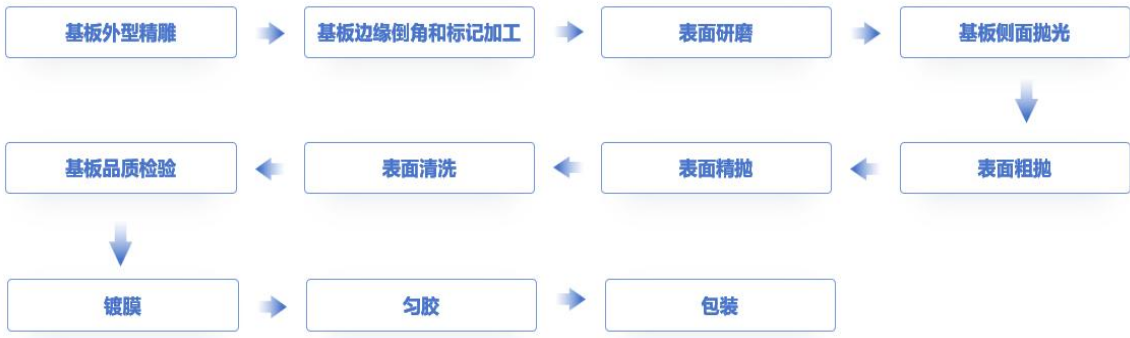
图 A. 1 石英基板加工流程图
