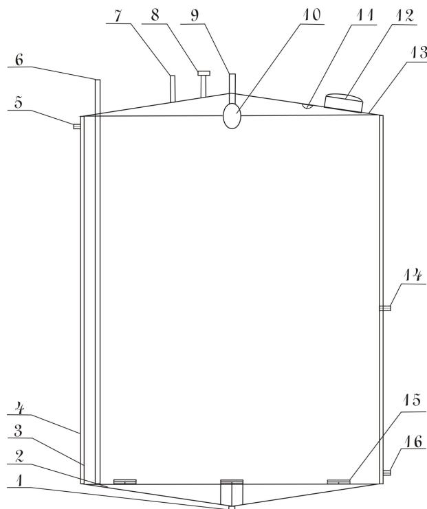
1、出料口，处理后酒液由此输出；2、下锥体；3、罐体；4、加热夹层；5、热水出口，跟恒温热水储罐相连；6、进气口，跟空气压缩机的空
