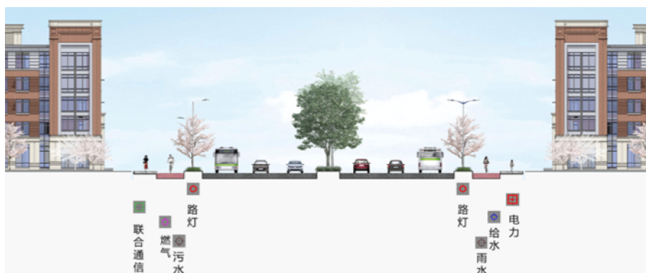
图 14 双向六车道公路市政化改造后断面示意图
