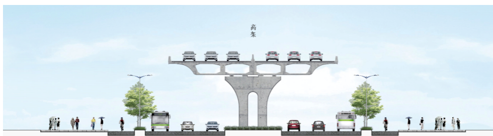
图 8 环城路快速化改造（高架式）横断面示意图
