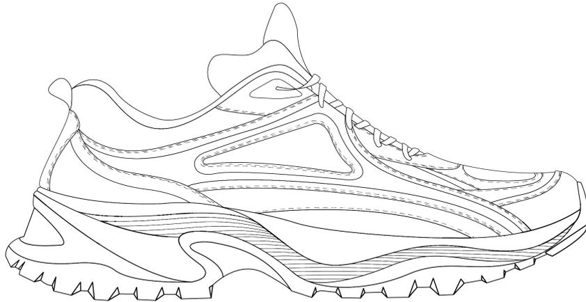
图 D.1 徒步鞋 (多片连接式) 帮面结构示意图
