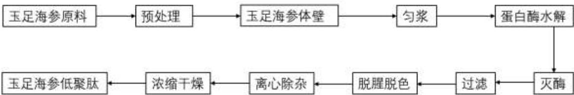
图1 玉足海参低聚肽酶解工艺流程
