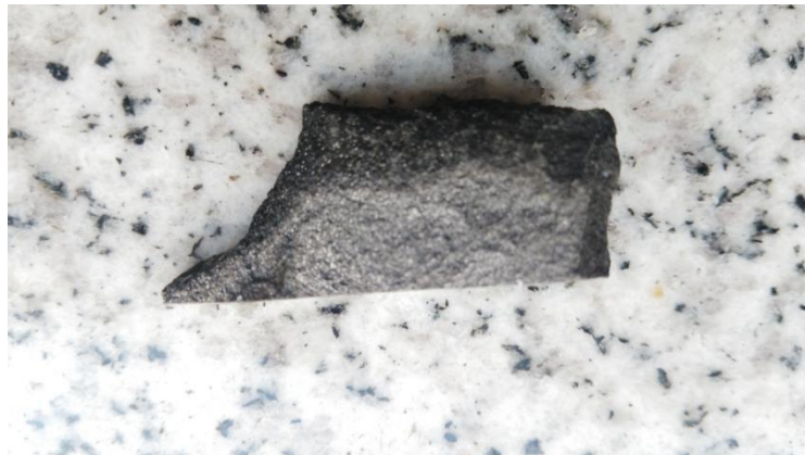
图 18 机体 HT250 底平面 热裂缺陷形貌
