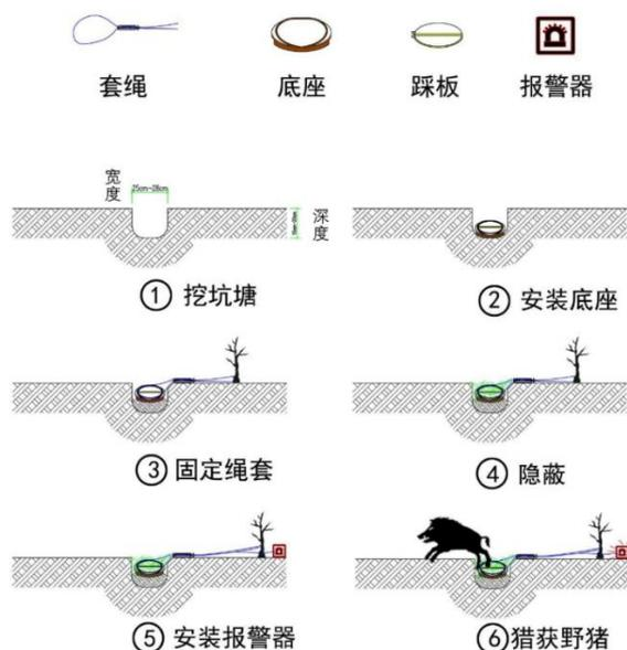
图 2 脚套猎捕技术路线图
