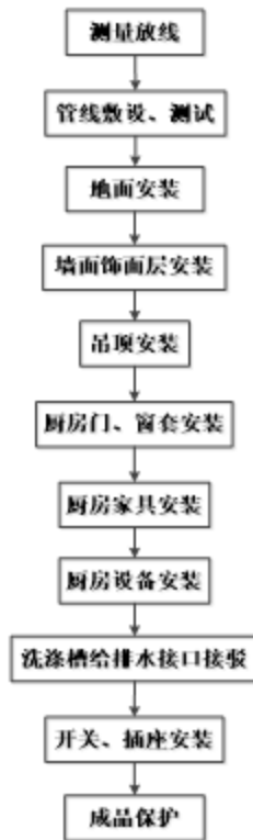
图1 集成厨房安装施工工艺流程
