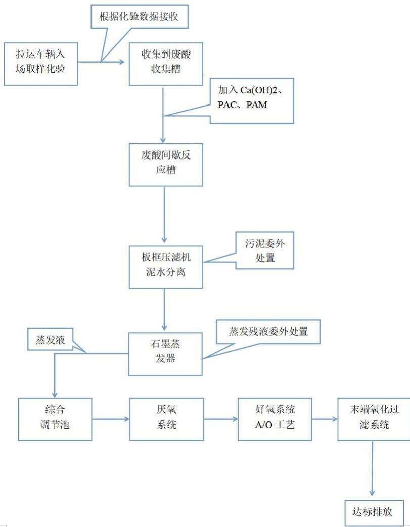
图 1 综合废液无害化处置流程示意图
