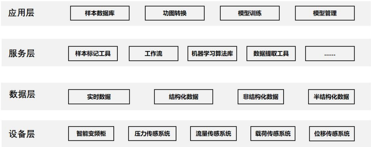
图 A. 1 抽油机井生产调参系统架构图
