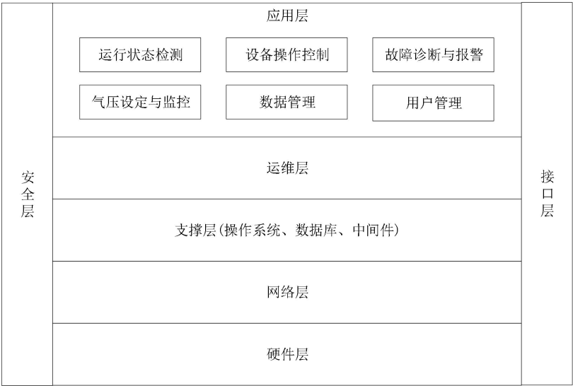
图 1 基于滤棒成型机组的爆珠高速精准植入系统架构图
