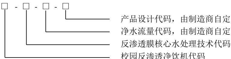
示例：XCJC-RO-10-A01 表示为净水流量 1.0L/min，设计代码为 A01，采用反渗透膜作为核心水处理技术的商用反渗透净饮机。
