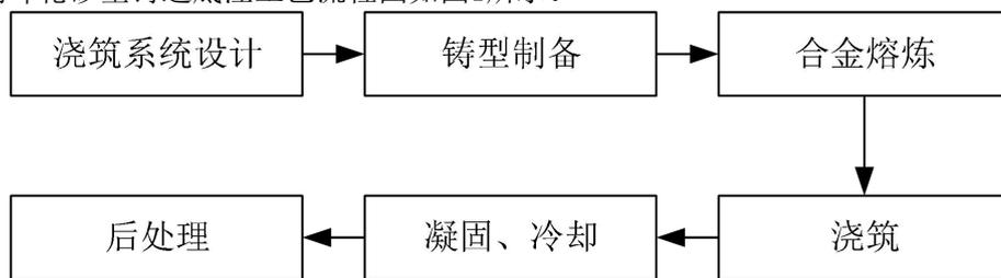
图1 镍铝青铜叶轮砂型铸造底注工艺流程图
