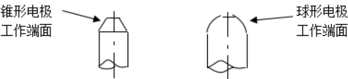
图1 锥形电极与球形电极工作端面
