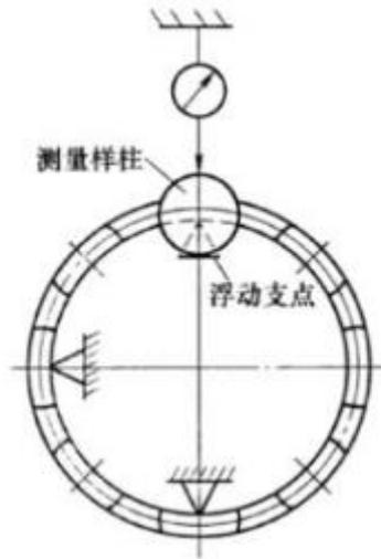
图9 兜孔中心对内孔中心径向距离变动量的测量
