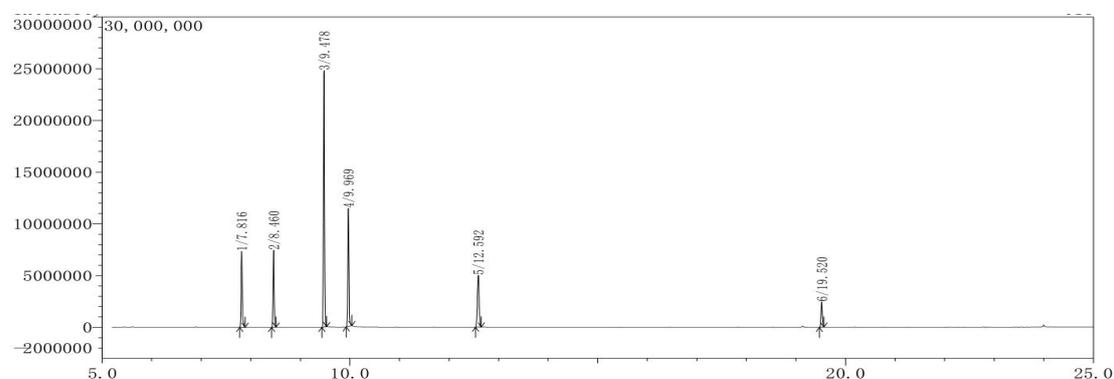
1—1,2-二氯苯-d<sub>4</sub>； 2—硝基苯-d<sub>5</sub>； 3—邻氨基苯甲醚； 4—对氨基苯甲醚； 5—对硝基苯甲醚； 6—菲-D<sub>10</sub>
