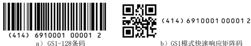
图 C.7 物理位置的全球位置码的条码表示
