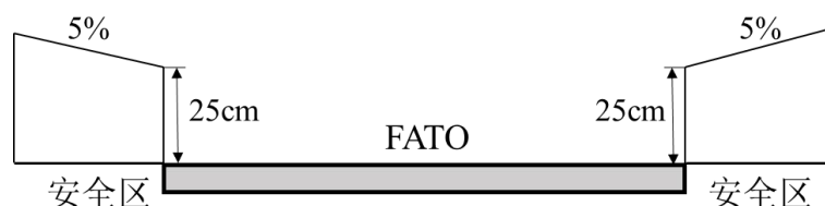
图 8.4.3 因功能要求设置于安全区内物体的限高示意图
