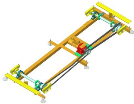
图 A. 5 轻载偏心升降台结构示意图
