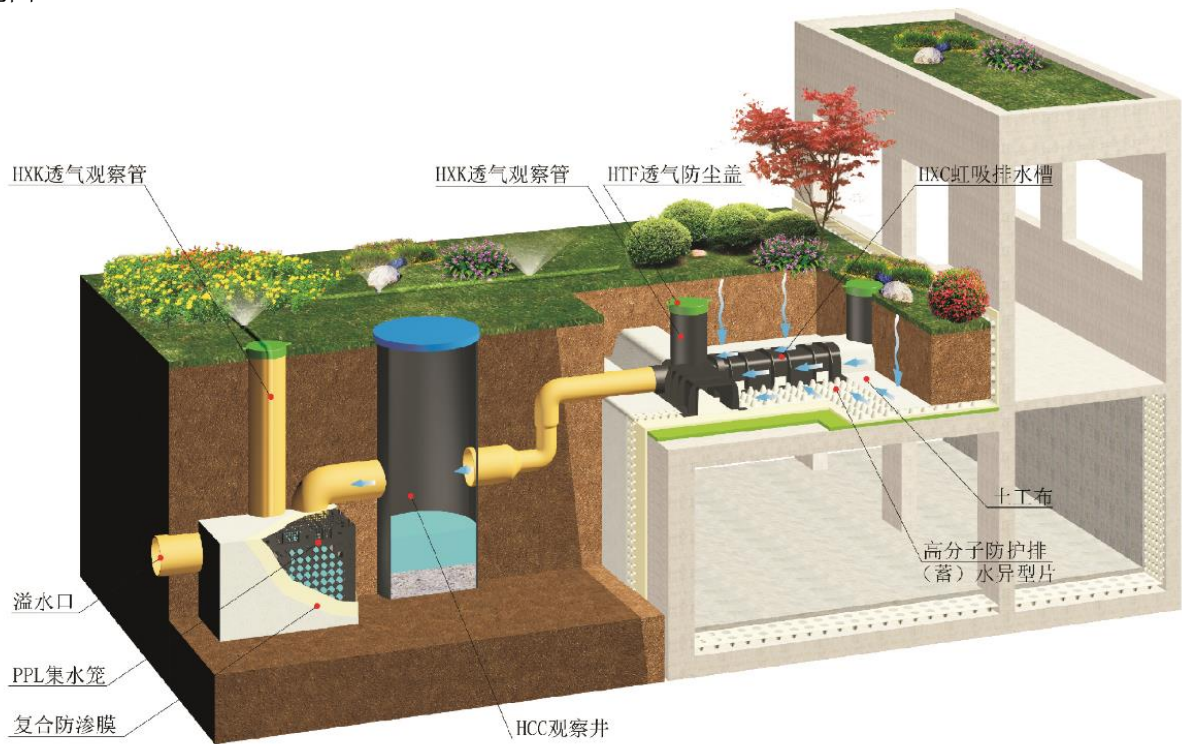
图A. 1 典型的 pdsG50 防排水集成系统模型
