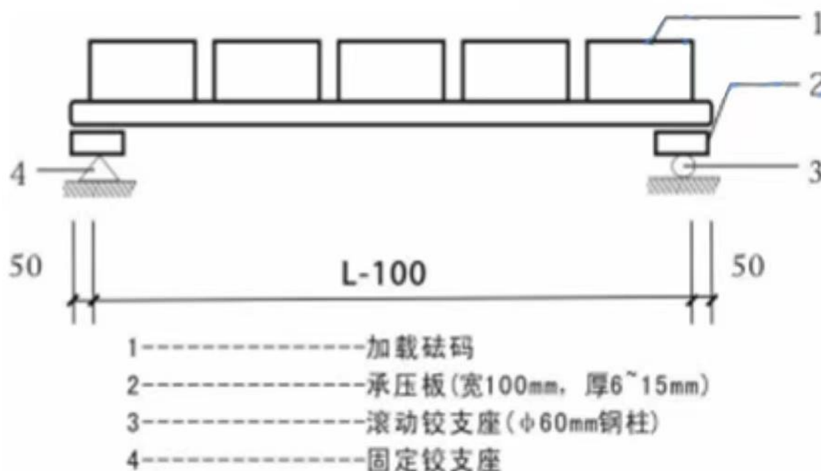
图3 抗弯破坏荷载试验装置
