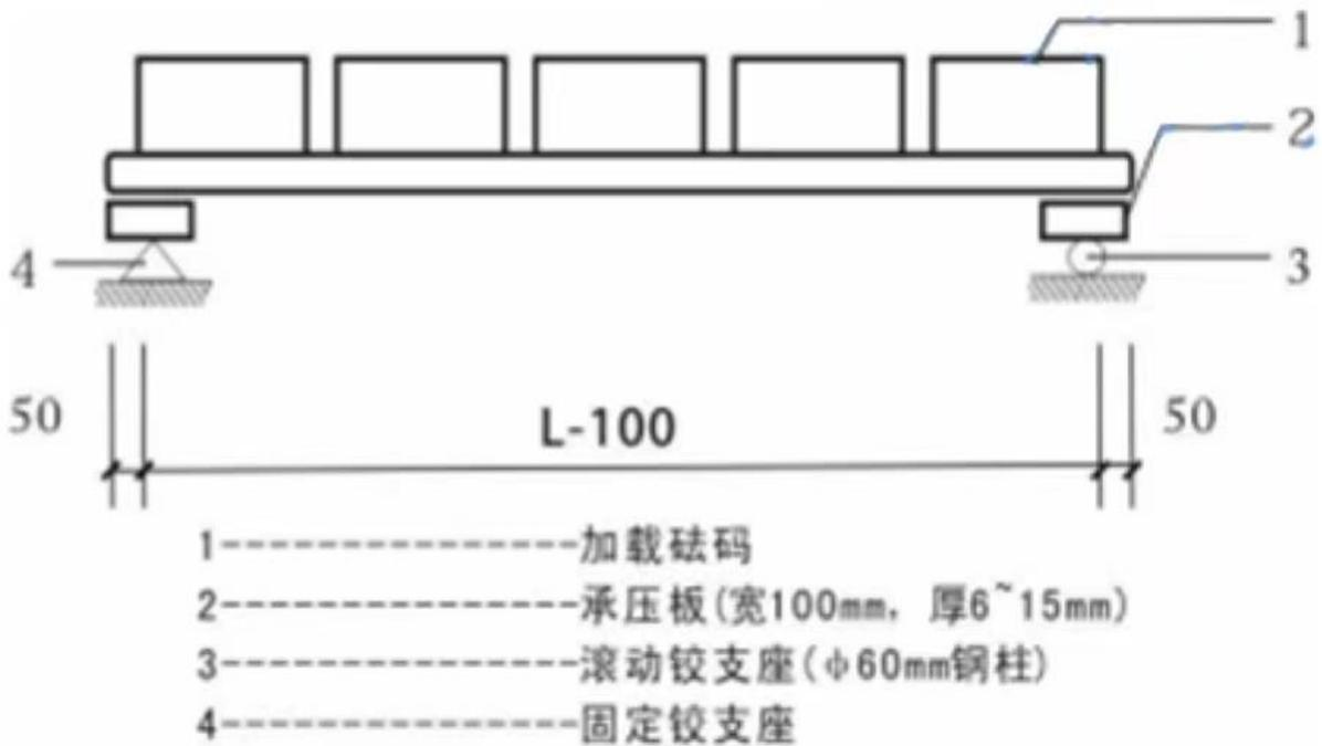
图3 抗弯破坏荷载试验装置
