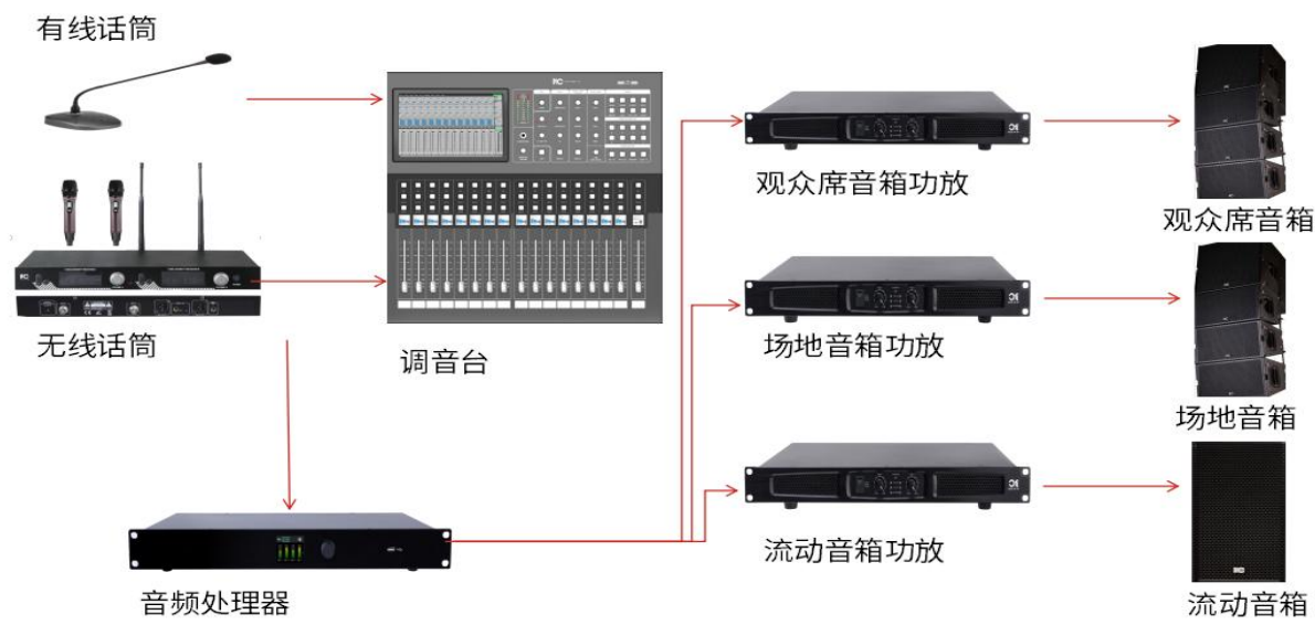
图5 大型体育馆扩声系统连接示意图
