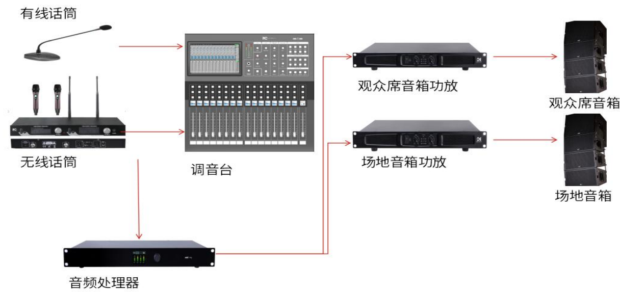
图6 中型体育馆扩声系统连接示意图
