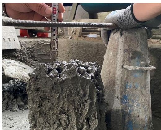
图 6 混凝土拌合物坍落度试验
