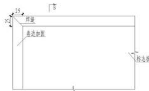
标志板边缘卷边加固大样图 1:4
