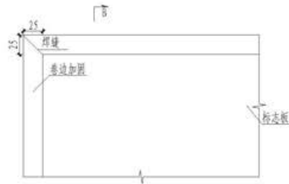
标志板边缘卷边加固大样图
