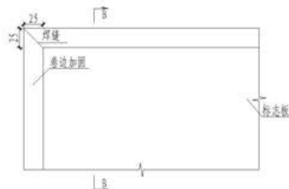
标志板边缘卷边加固大样图
