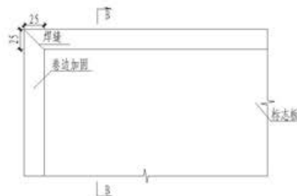
标志板边缘卷边加固大样图
