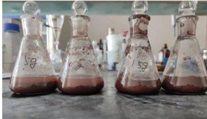
图 5 土壤样品量 5g、10g、15g、20g 时锥形瓶内样品状态
