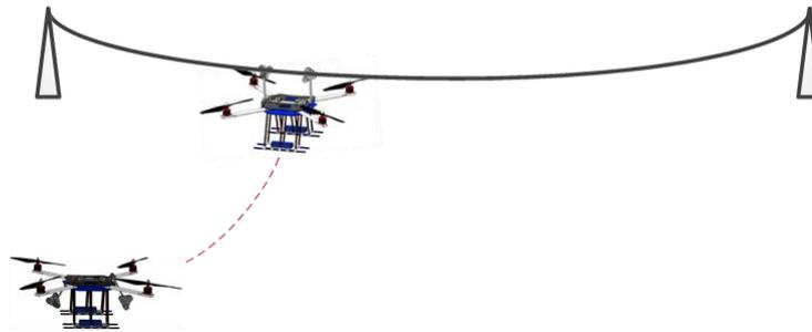
图1 飞行上下线试验示意图
