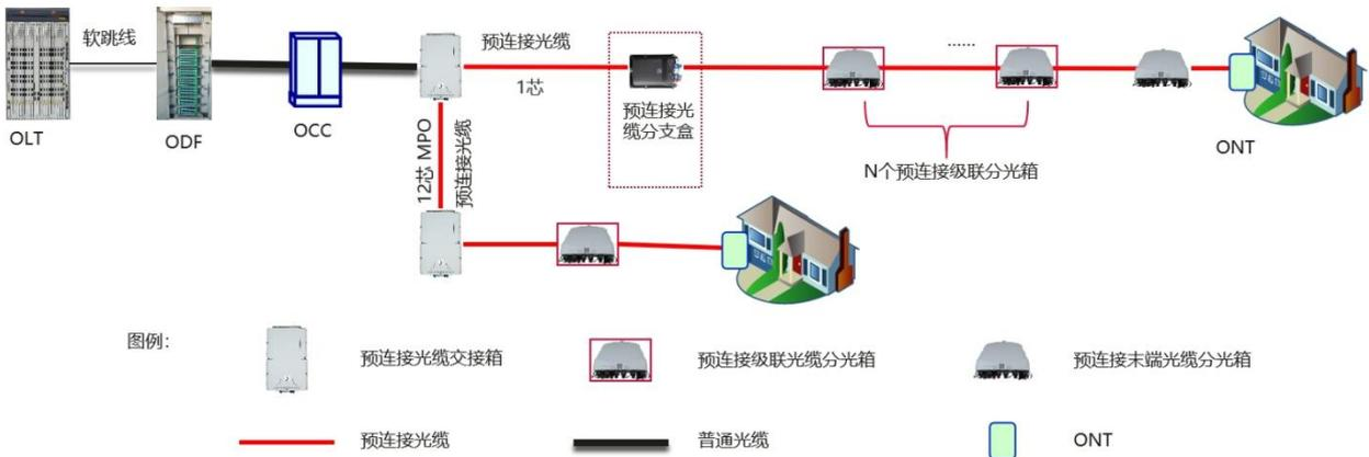
图2 预连接设备上联传统光缆交接箱ODN组网结构示意图
