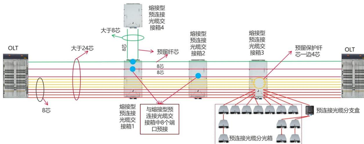
图4 熔接型预连接光缆交接箱纤芯配置示意图
