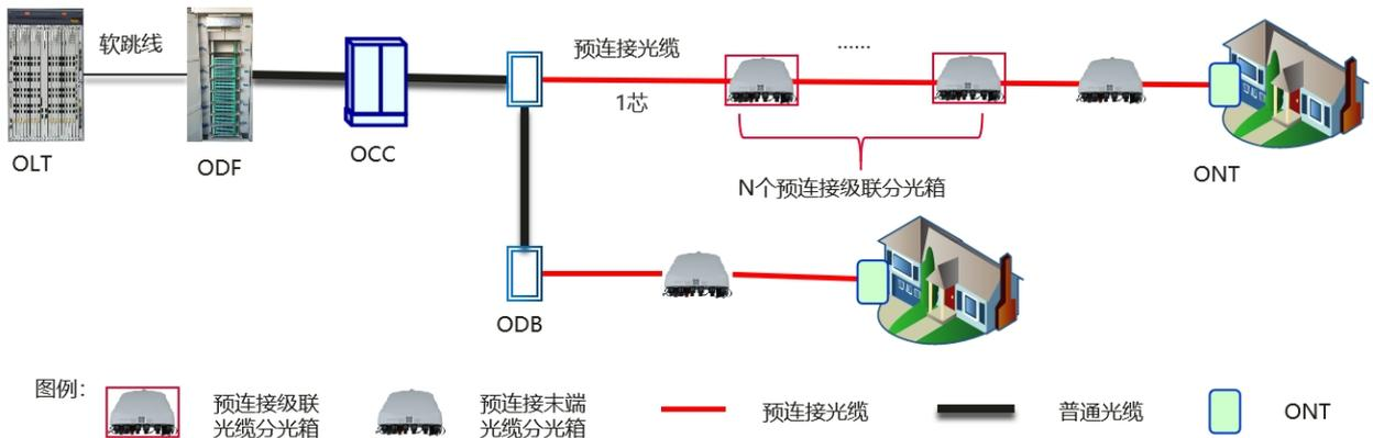
图3 预连接设备上联传统光缆分纤箱ODN组网结构示意图
