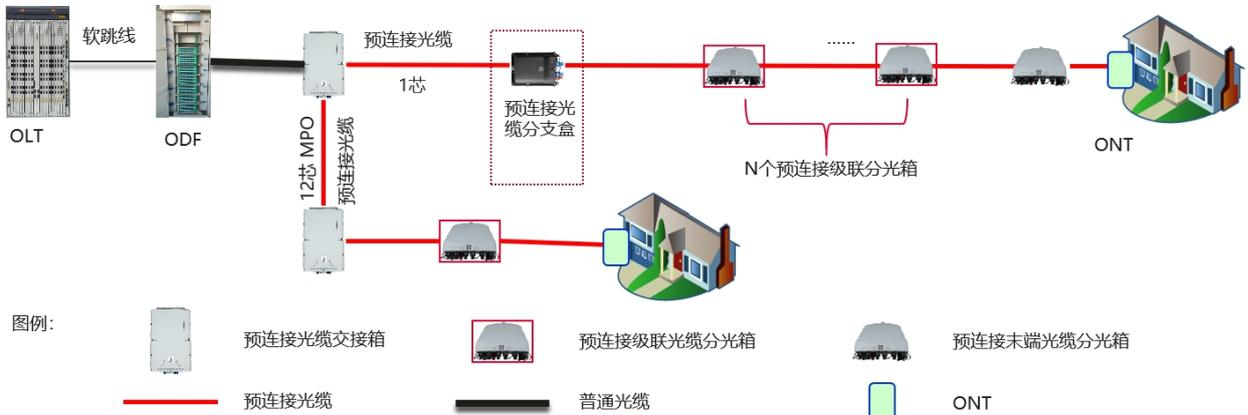
图1 全新建预连接ODN组网结构示意图
