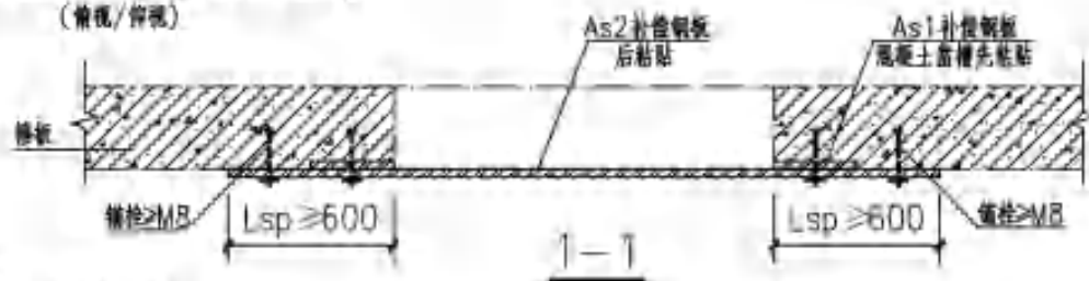
粘钢补偿加固连续板开洞
