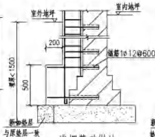
浅埋基础做法 (原基础深度 < 1500)
