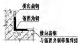
横向扁钢与锚固角钢连接做法
