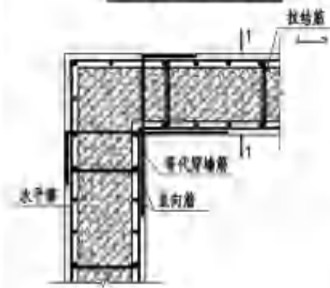
转角墙双面加固
