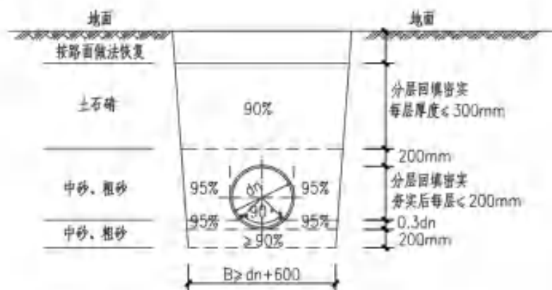
② 人行道、铺装及绿化带下基础做法
