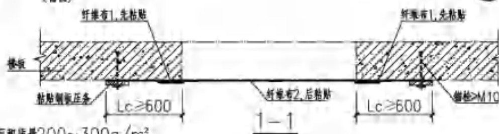
粘贴纤维布补偿加固简支板开洞
