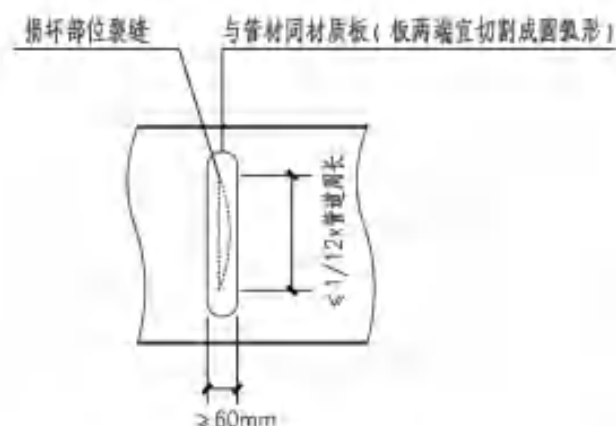
HDPE管局部损坏裂缝修补示意图
