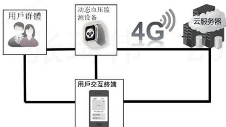
图 1 4G 动态血压监测设备应用架构
