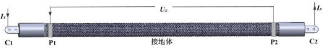
图 3 四极法测量单位长度电阻示意图
