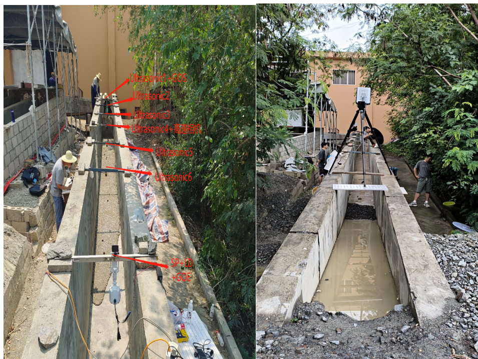
(1) 相机和超声波测距仪布设示意图 (2) 毫米波雷达布设示意图
