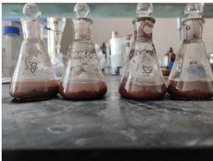
图 5 土壤样品量 5g、10g、15g、20g 时锥形瓶内样品状态
