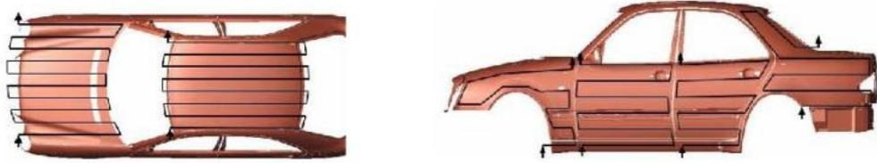
应选用横向喷涂方式以保证稳定的喷涂质量，横向喷涂方式如图3所示。
